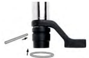
**ABBILDUNG 18** – Befestigen des Einsatzes
