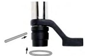
**ABBILDUNG 16** – Befestigen des Einsatzes
