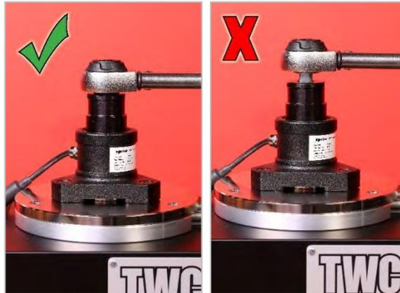
**FIGURA 15** – Posicionar Uma Chave Dinamométrica.
