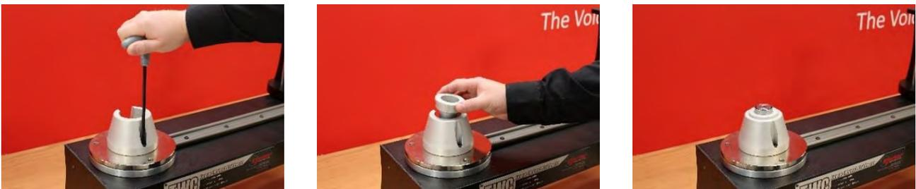
**FIGURA 27** – Instalação do Kit de Suporte do Transdutor Estático
