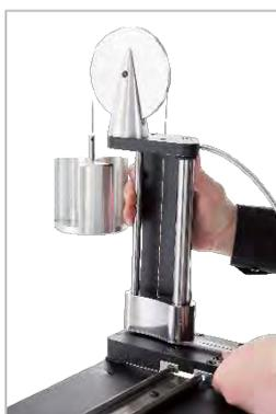
**FIGURA 12 – Inserir O Contrapeso No Trilho De Reação.**
