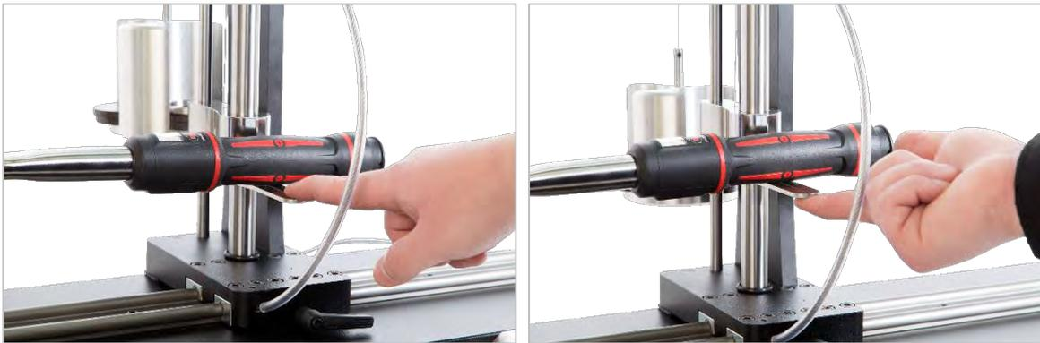
**FIGURA 18** – Confirmar Se A Chave Dinamométrica Se Encontra Numa Posição Horizontal.
