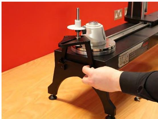
**FIGURA 28 – Colocação da Placa de Reação de Curta Extensão**
