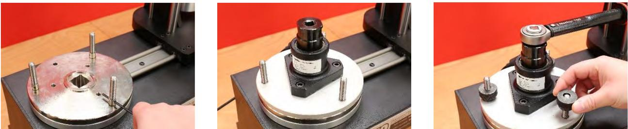
**FIGURA 31** – Instalação do Kit FMT de Libertação Rápida
