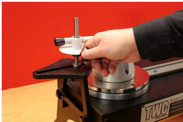
**FIGURA 29 – Ajustar o Ponto de Reação da Placa de Reação de Curta Extensão**
