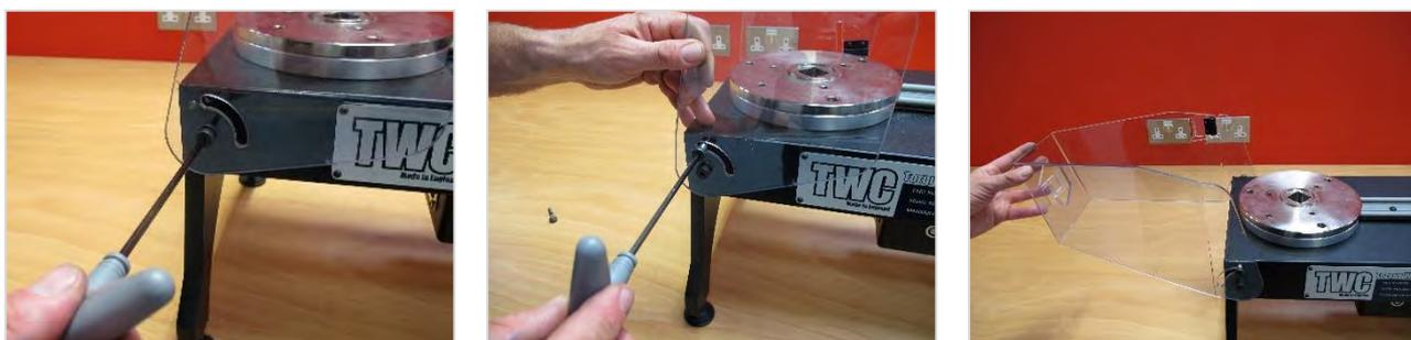
**FIGURA 7** – Encaixar a Proteção.
