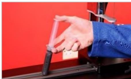
**FIGURA 22** – Aplicação do Lubrificante
