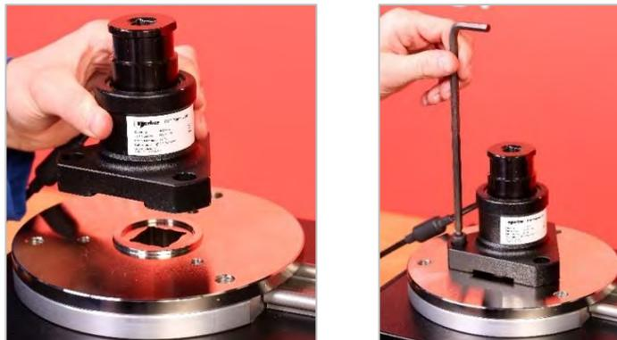
**FIGURA 14 – Instalar Um Transdutor Com Fixação De Flange (FMT).**
