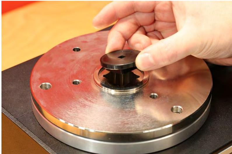
**FIGURA 26** – Instalação do Adaptador de Encaixe Quadrado
