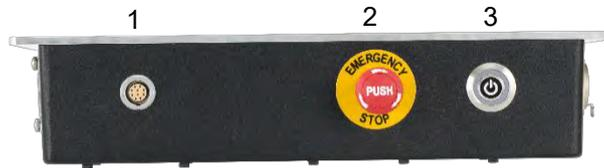
**FIGURA 2 – Visão Frontal Da Caixa De Comando.**
