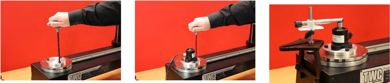
**FIGURA 30** – Instalação do Kit FMT Adaptador 25
