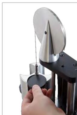
**FIGURA 17** – Adicionar Peso Ao Contrapeso De Reação.
