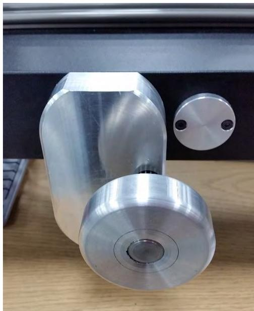
Utilize o adaptador da engrenagem de acionamento manual I/P para obter o valor correto na ferramenta de binário.
