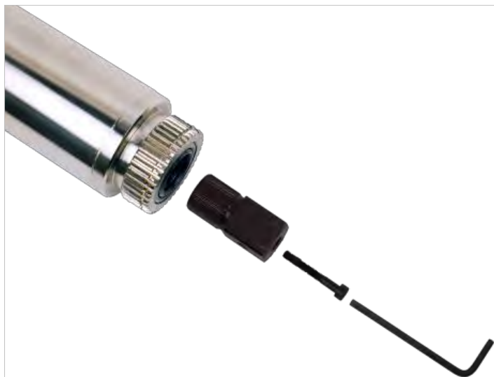
RYSUNEK 12 — Wymiana kwadratowego zabieraka napędowego
