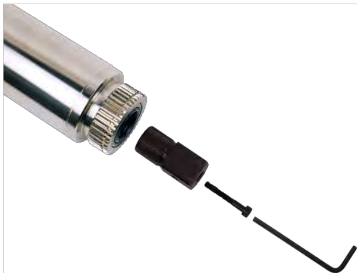
RYSUNEK 12 — Wymiana kwadratowego zabieraka napędowego
