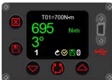
FIGUR 54 – börvärdesresultat för Vridmomentgranskning (visar uppnått vridmoment och skruvrörelse i grader)
