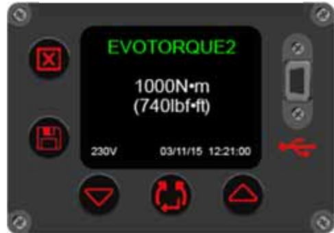
KUVA 18 – Työkalun kapasiteetti, käyttöjännite, kellonaika ja päivämäärä
