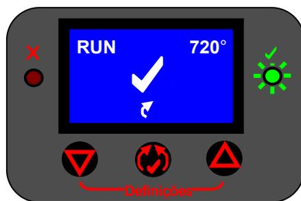
**FIGURA 26** – Junta concluída com sucesso. É apresentado um visto e um led verde.
