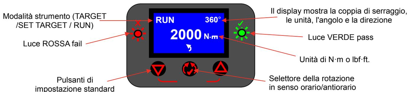
**FIGURA 2 – Caratteristiche dell'interfaccia utente**
