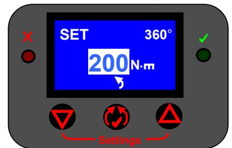
FIGURA 23.a – Impostazione di TORQUE (Coppia di serraggio) e ANGLE (Angolo)
