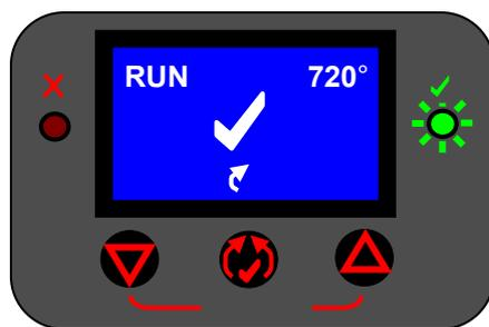
**FIGURA 26** – Giunto serrato con successo. Sono visualizzati il segno di spunta e la luce verde.
