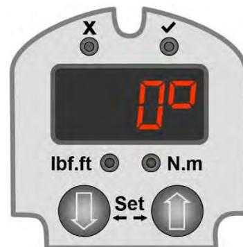
ABB. 5b - Werkzeugwinkelanzeige
