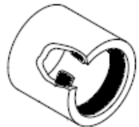
ILUSTRACIÓN 11 – Ubicación del silenciador
