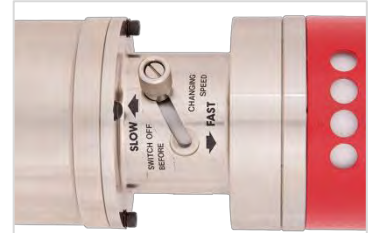
FIGUR 10 – 'FAST' (hurtig) hastighed ovenfor, 'SLOW' (langsom) hastighed nedenfor.
