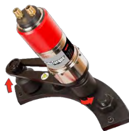
FIGUR 6 – Reaktion mod uret (tilbage)
