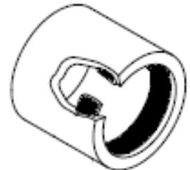
**ABB. 11** – Einbaulage des Schalldämpfers
