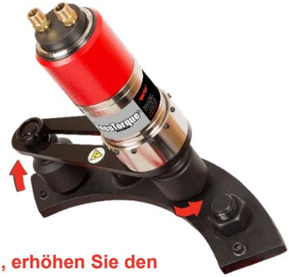
**HINWEIS:** Wenn die Schraube nicht ausgeschraubt werden kann, erhöhen Sie den Luftdruck für das Werkzeug. Dabei darf der maximale Luftdruck des Geräts nicht überschritten werden.
