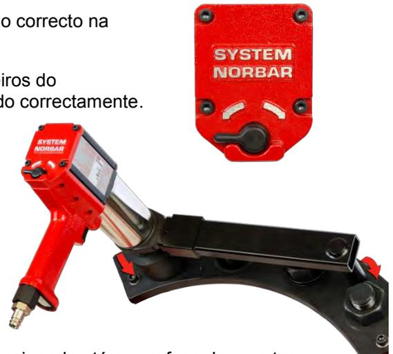
**SUGESTÃO:** Se não for possível desapertar o parafuso, aumente a pressão de ar na ferramenta. Não utilize pressão de ar excessiva.
