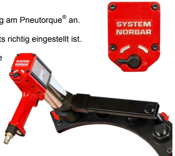
**HINWEIS:** Wenn das Befestigungselement nicht ausgeschraubt werden kann, erhöhen Sie den Luftdruck für das Werkzeug. Verwenden Sie aber keinen zu hohen Luftdruck.
