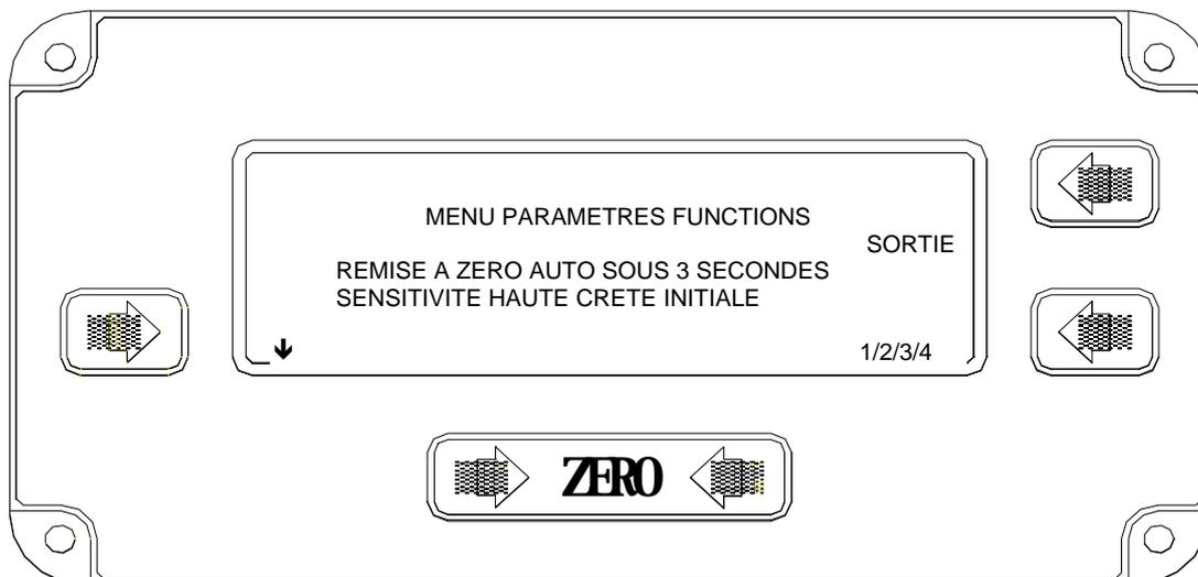
Sélectionner le paramètre fonctions souhaité en appuyant plusieurs fois sur la touche '↓' jusqu'au clignotement du texte. Pour changer le réglage, appuyer sur la touche en bas, à droite de l'écran, cette touche change de fonction suivant le paramètre sélectionné. Lorsque toutes les sélections ont été effectuées, appuyer sur la touche 'SORTIE'.
