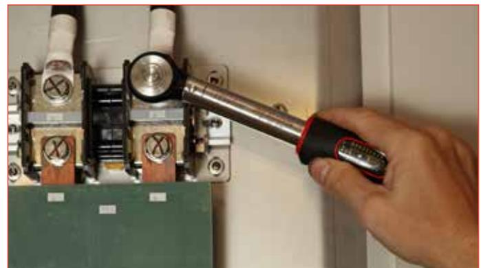
TTi20 nicht magnetisch, bei Anwendung an einem MRT-Gerät
