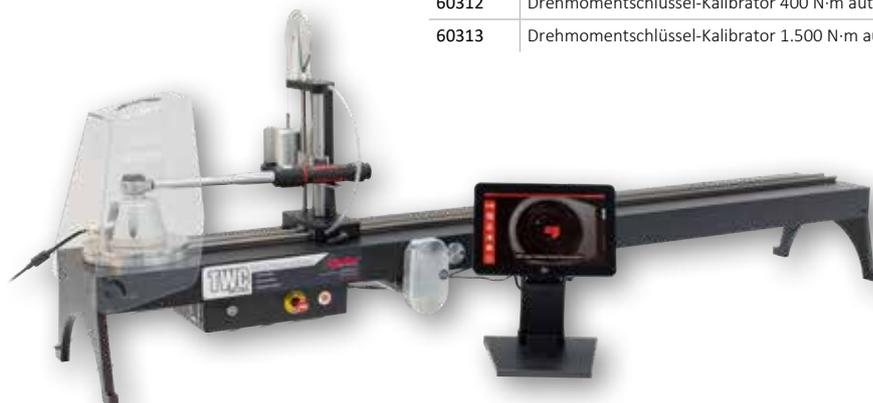
*Drehmomentschlüssel-Kalibriervorrichtung Auto (TWC), hier dargestellt mit einem Professionellen Schlüssel, Modell 200 und einem angeflanschten Messumformer (nicht enthalten)*
