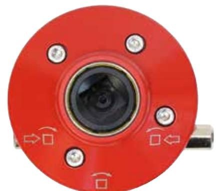
*Einstellung Rücklaufsicherung im Uhrzeigersinn*
