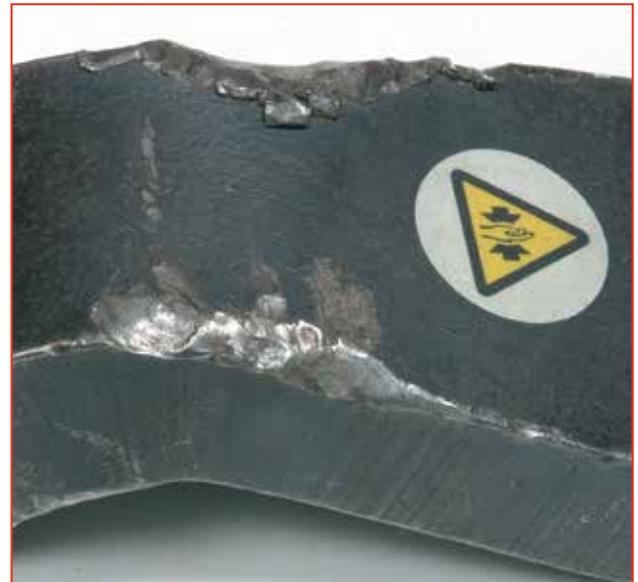
An diesem geschädigten Fuß sind Anzeichen einer schlechten Reaktion zu erkennen. Die Reaktion wurde an der falschen Stelle des Fußes vorgenommen und die Gratbildung deutet darauf hin, dass der Fuß vom Reaktionspunkt abrutschte.
