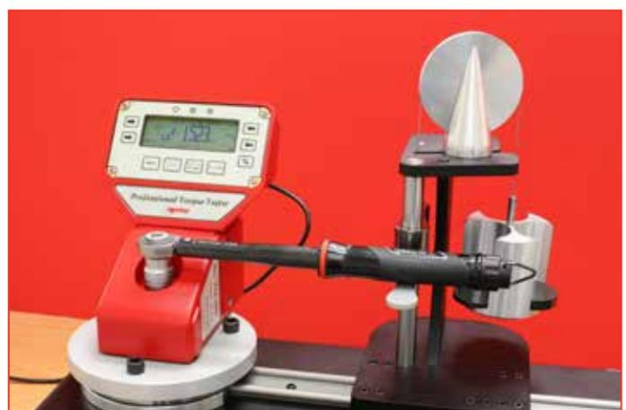
60323 Pro-Test und statisches Drehmomentblock-Adapter-Set
