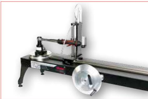
*Drehmomentschlüssel-Kalibrator (TWC) Manuell dargestellt mit einem flanscmontierten Messwertgeber und einem Drehmomentschlüssel Modell 100 (nicht enthalten)*
