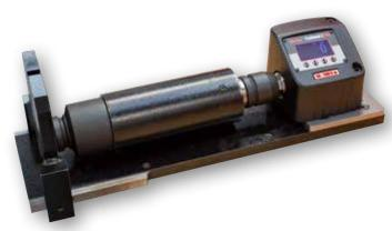
Elektrowerkzeug-Prüfvorrichtung abgebildet mit TruCheck™ 2 Plus 1100 (nicht enthalten) und Adapterplatte 39994 (nicht enthalten)
