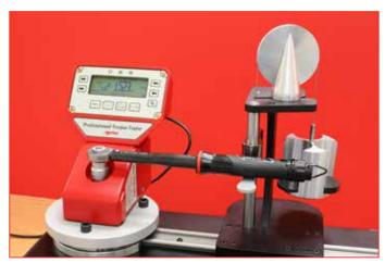
60323 Pro-Test und statisches Drehmomentblock-Adapter-Set
