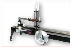
Drehmomentschlüssel-Kalibrator (TWC) Manuell dargestellt mit einem flanschmontierten Messwertgeber und einem
