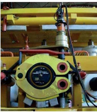
Unterwasser 63.000 N·m Rohrschellenwerkzeug im Test
