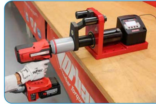
Dispositif d'essai pour outils électriques
