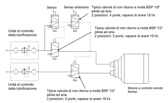
FIGURA 7 - Esempio di circuito pneumatico
