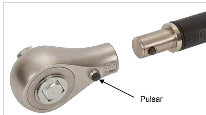
**NOTA:** Todas las herramientas NorTronic® son mangos de torsión con una espita de 16mm. Si desea cambiar a un extremo de llave diferente, pulse la solapa del cabezal de trinquete y tire para soltarlo.
