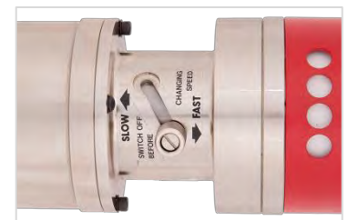
FIGUUR 12 – 'FAST'-snelheid boven, 'SLOW'-snelheid onder.
