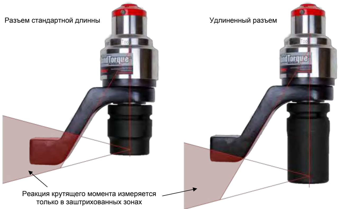
ЧЕРТЕЖ 6 – Серия Compact (безопасная рабочая зона)
