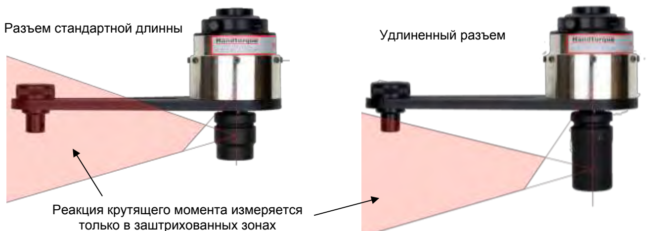
ЧЕРТЕЖ 3 – Стандартная серия (безопасная рабочая зона)
