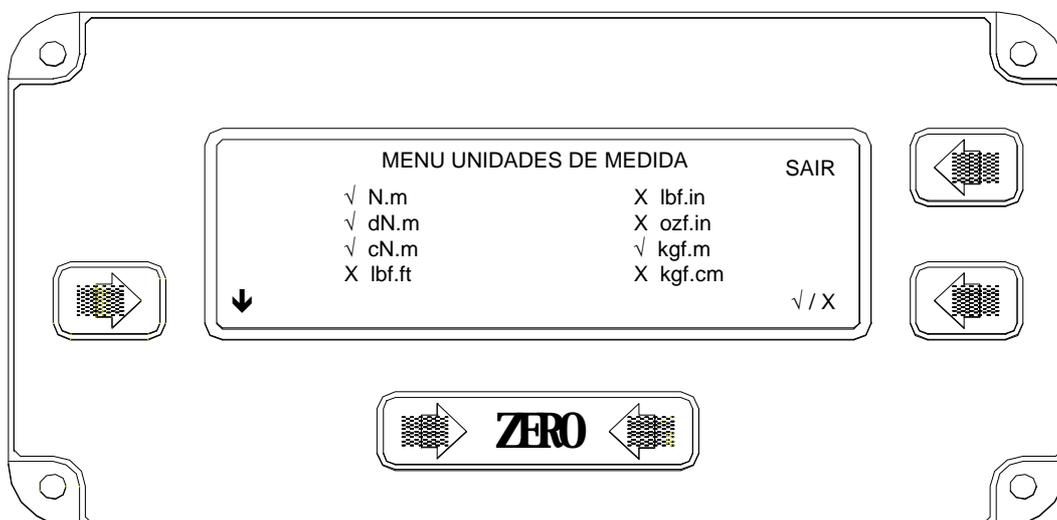
Para validar/invalidar determinada unidade de medida prima repetidamente o botão '↓' até que a unidade pretendida fique a piscar. Então prima '√ / X' (√ = valida, X = invalida). Depois de efectuar todas as selecções pretendidas, premir 'SAIR'.
